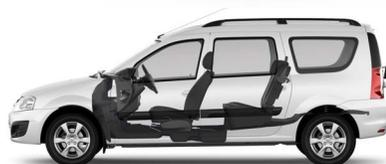
Сиденья третьего ряда можно сложить, а можно и вынуть из автомобиля – без применения инструмента. При полностью сложенных задних сиденьях LADA Largus превращается в мини-грузовик с багажником объемом 2350 литров.
